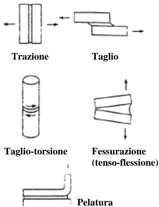
Figura 2 - Tensioni possibili nei giunti incollati
