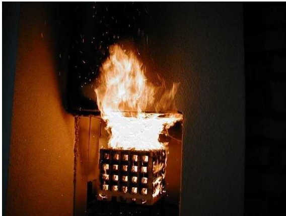
Foto: test sul fuoco per facciate
