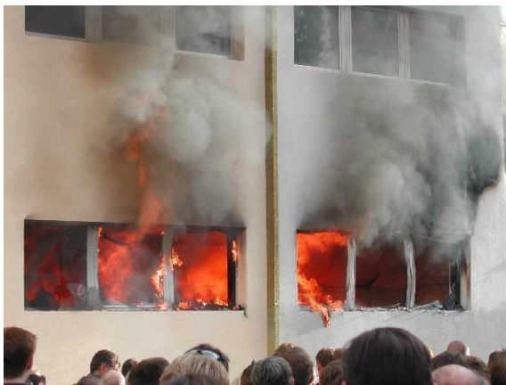
Foto: test sul fuoco per facciate (dopo 27 minuti)
