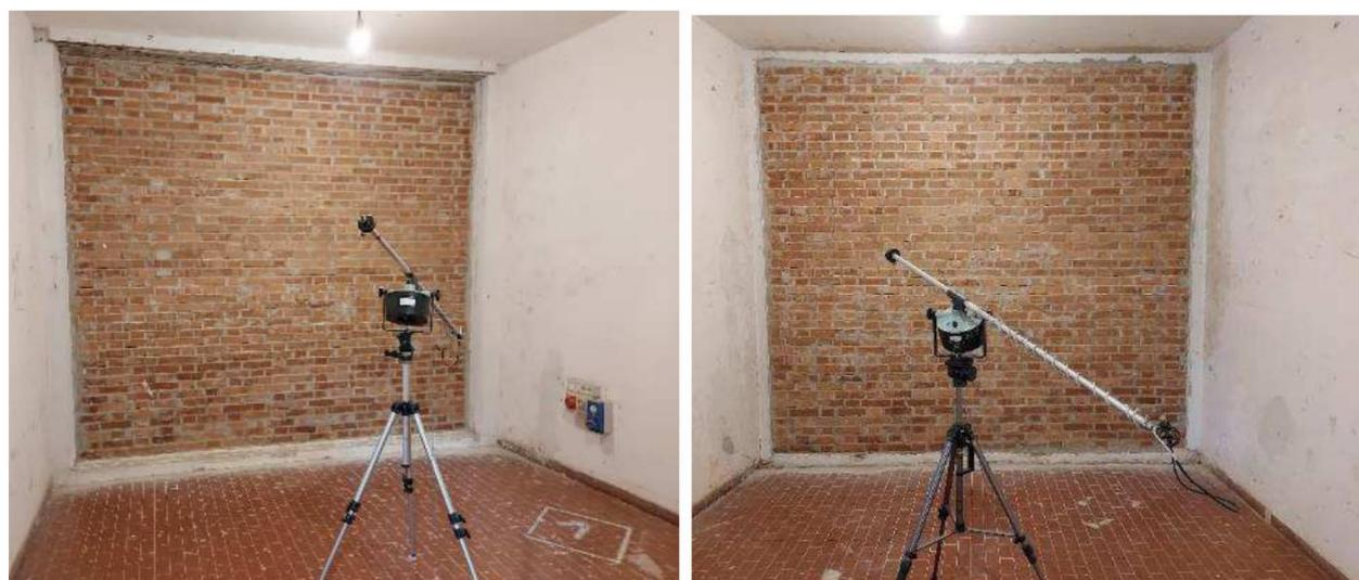
**Camere di misura, muro di supporto per le prove eseguite con rivestimento a cappotto**
