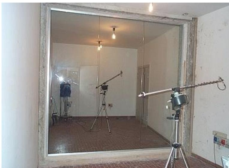
**Laboratorio di acustica ITC-CNR: camere per la determinazione del potere fonoisolante di componenti per partizioni esterne ed interne**
