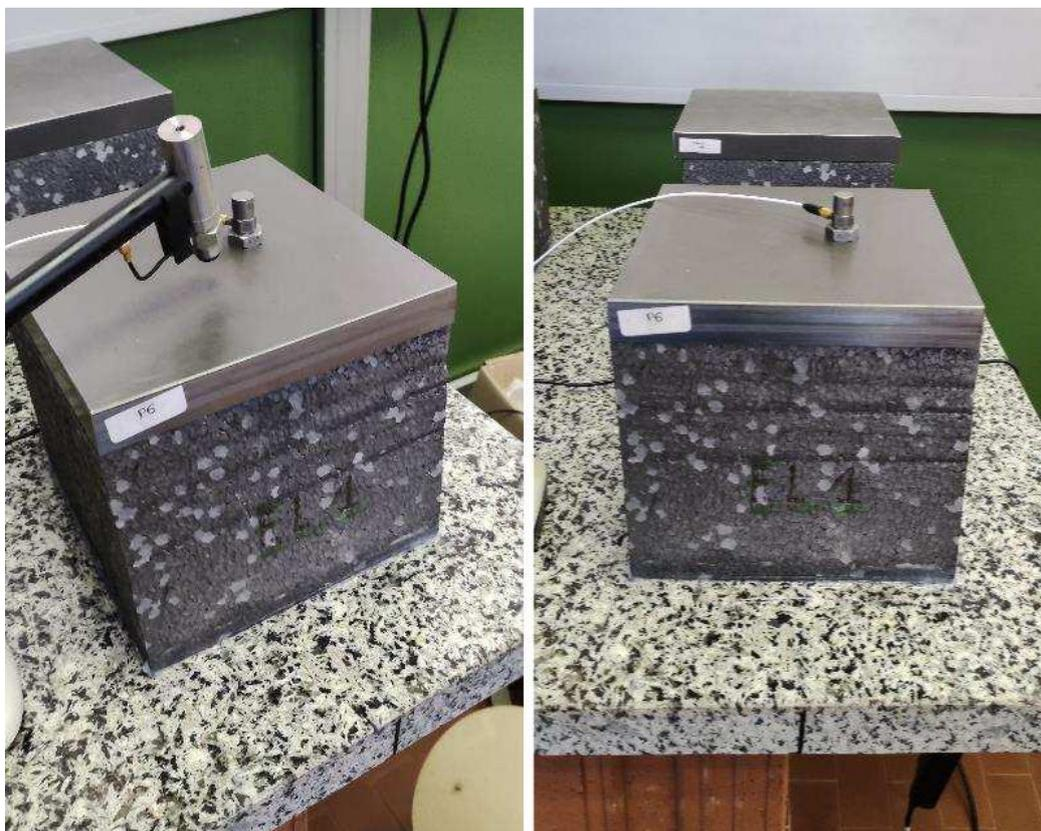
**Campioni e strumentazione per la determinazione della Rigidità Dinamica**
