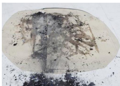
Tetto piano con EPS e rivestimento cementizio sovrastante – Propagazione estremamente limitata dell'incendio sulla superficie del tetto e danni minimi al materiale isolante.
