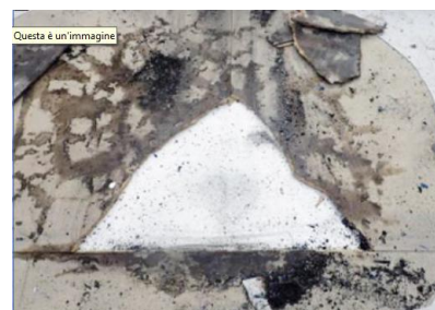
Tetto piano con EPS e rivestimento cementizio sovrastante – Propagazione estremamente limitata dell'incendio sulla superficie del tetto e danni minimi al materiale isolante.
