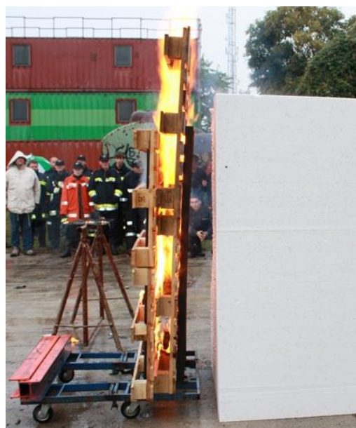
Foto: Pallet di legno in fiamme posto di fronte a un blocco di EPS
