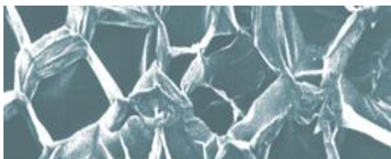
Foto: Struttura cellulare dell'EPS al microscopio
