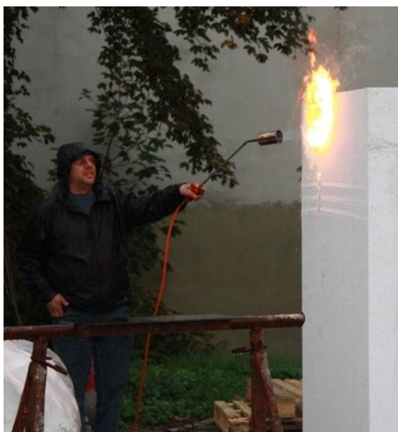
Foto: Blocco di EPS sottoposto a fiamma diretta
