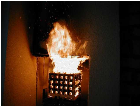
Foto: test sul fuoco per facciate
