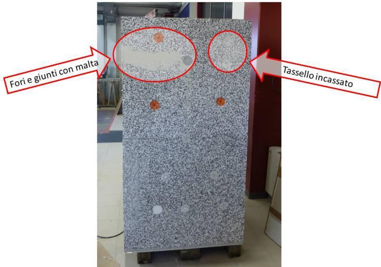
Immagine della parte destra DX del manufatto con sistema di posa del cappotto corretto nella parte bassa (tasselli con e senza rondelle) e con errori di posa nella parte alta
