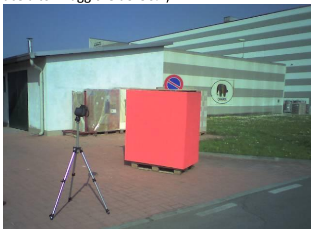
Indagini su manufatto con coefficiente di assorbimento solare medio con termocamera fissa 28/03/2012
